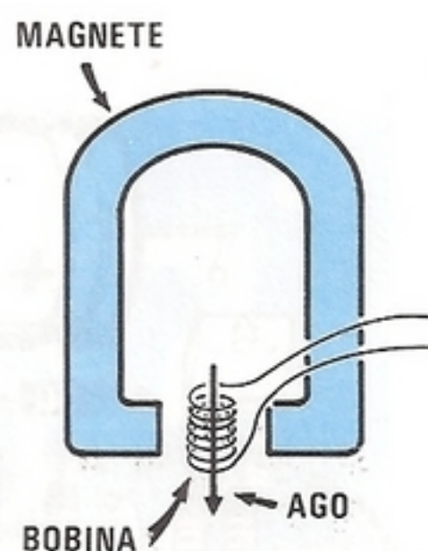
Fig.3 In un pick-up "moving coil" la parte mobile è costituita da una bobina collegata direttamente alla puntina. In tal modo si riduce notevolmente il peso e di conseguenza l'inerzia della parte mobile, con il conseguente vantaggio di migliorare la banda passante.
